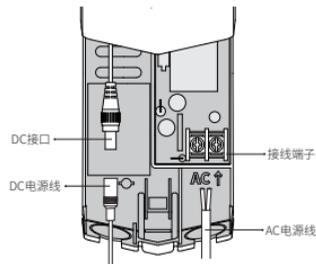
**⚠️ 注意：安装时，请注意火线、零线线头保持安全距离，以防短路。**
